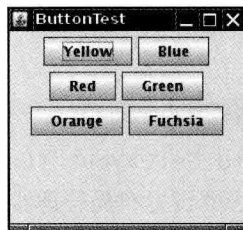
图 12-7 改变面板尺寸后自动重新安排按钮
