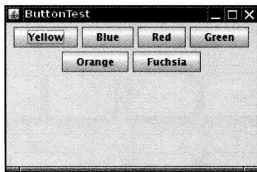
图 12-6 用流布局管理六个按钮的面板
